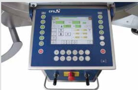
Mit der Ausführung Touch wird die Bedienung über ein Touchdisplay zu großen Teilen realisiert, ferner ist die Übersicht benutzerfreundlicher gehalten.
